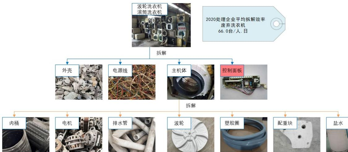
图4.5 洗衣机处理工艺流程及平均拆解效率
