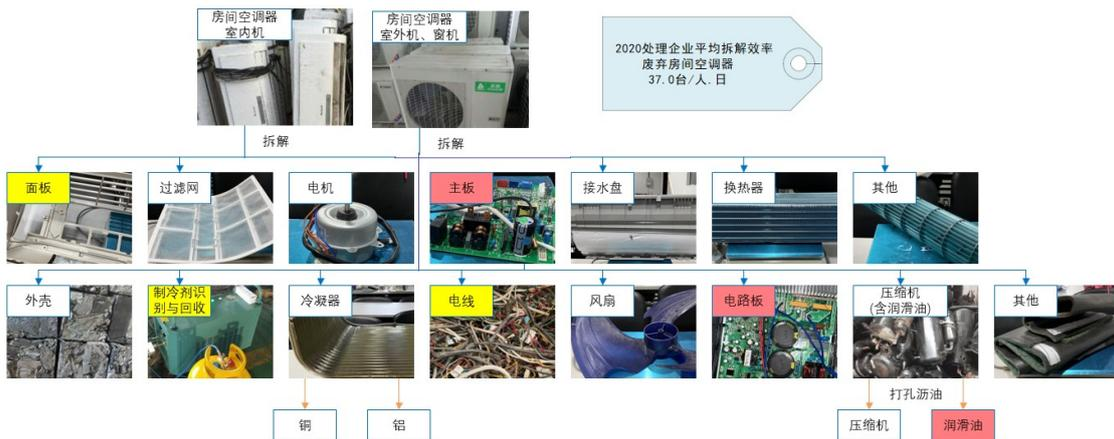
图4.6 房间空调器室内机处理工艺流程及平均拆解效率
